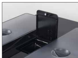
Réceptacle d'insertion manuelle
