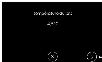
**Température du lait :** la température idéale du lait est de 4 °C. Elle ne doit en aucun cas dépasser 12 °C. En cas de température supérieure à 12 °C, la machine ne doit pas proposer de recettes à base de lait.
