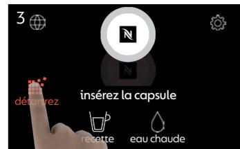
3 Dès le symbole « détartrage » apparaît en rouge, la machine doit être détartrée. Appuyez sur le symbole « détartrage » rouge et suivez les instructions à l'écran. Le détartrage de la machine prendra environ 10 minutes.
