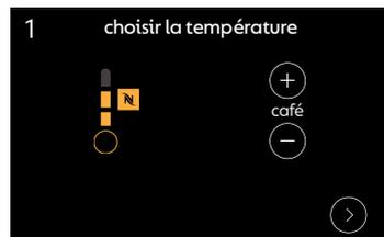
Définissez la température du café avec +/- . Appuyez sur le symbole « suivant » pour accéder au menu Configuration. **Nespresso** recommande d'utiliser les températures affichées.
