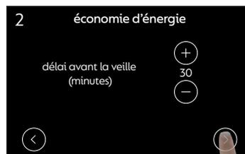
Sélectionnez le délai après lequel la machine entre en veille. Dans ce mode, la machine se rallume automatiquement dès qu'un utilisateur s'approche.
