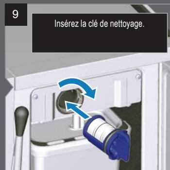
**i** La procédure de nettoyage démarre automatiquement une fois la clé de nettoyage insérée.
