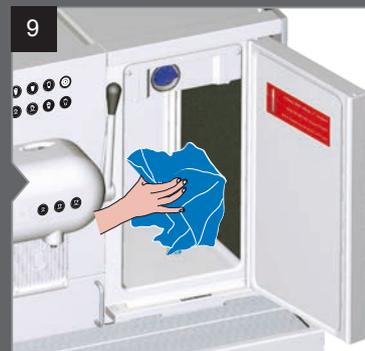
Essuyez soigneusement le tube d'aspiration de lait avec sonde de température et capteur de niveau à l'aide d'une lingette jetable ou d'une serviette en papier.
